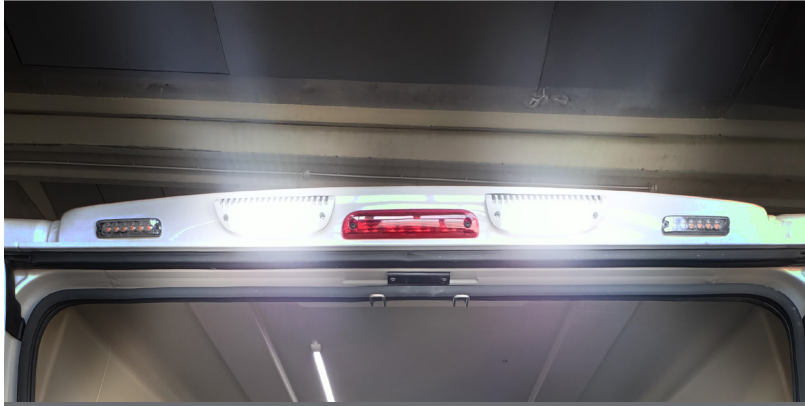
Luci illuminazione o lampeggianti arancio zona di carico posteriore e laterale. Lighting or amber flashing lights for rear and side loading area.
